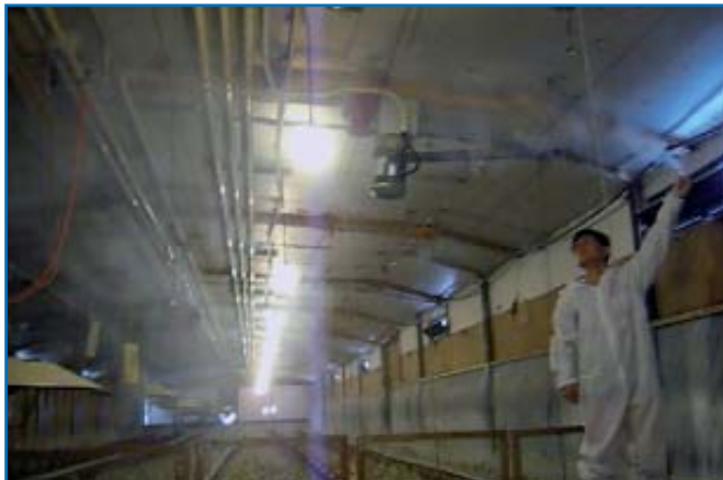
Figura 34: Upotreba testa dimom za proveru optimalnosti protoka vazduha i negativnog pritiska.
