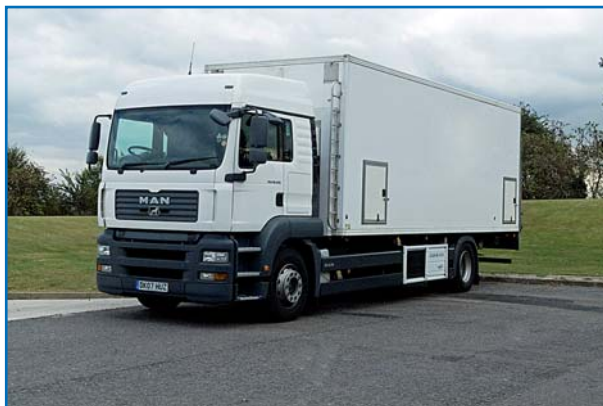
Figura 5: Tipična vozila sa kontrolisanom klimom za dostavu pilića.
